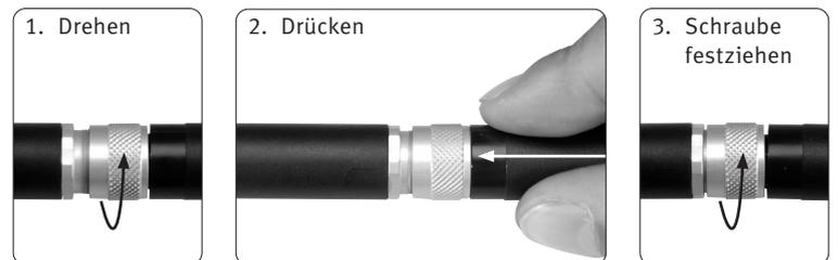
**!** Nur eine korrekt montierte und festgezogene Verbindung gewährleistet die angegebene IP-Schutzart.
