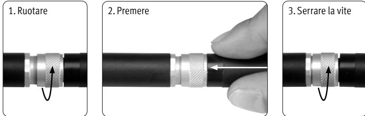
**!** Solo un collegamento correttamente realizzato e fissato garantisce il grado di protezione IP indicato.
