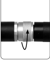
**!** Nur eine korrekt montierte und festgezogene Verbindung gewährleistet die angegebene IP-Schutzart.
