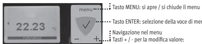
Nota: è possibile evitare un accesso non autorizzato al menu bloccando l'opzione "Display Menu" (se si utilizza il software HW4 > Device Manager (Manager strumenti) > Display).
