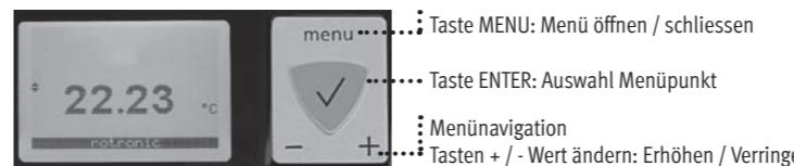
**Hinweis:** Der unbefugte Zugriff auf das Menü kann durch Sperren der Einstellung "Display Menü" verhindert werden (Verwendung der HW4-Software > Geräte-Manager > Display).
