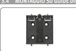
Con il kit di montaggio AC5002 (ordinabile a parte) è possibile montare il trasmettitore direttamente su una guida DIN TS35. A tale scopo, fissare i supporti DIN mediante viti direttamente sugli appositi fori presenti sul trasmettitore.
